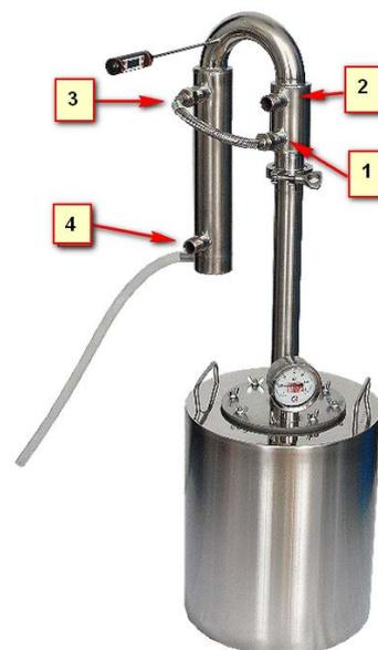
**Предохладитель** — отсоединяемый, с ниппелями (1 и 2), так что устройство можно использовать в качестве классического самогонного аппарата (прямоточника). Конструкция позволяет быстро перегонять брагу в спирт-сырец, при этом вода подаётся через ниппель (4) и отводится через ниппель (3).
